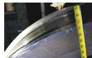
Imaginea nr. 11 - Urmă de frecare pe partea exterioră a roții
