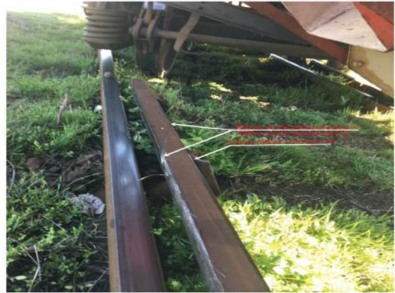
Foto 3.4: punctele de escaladare/cădere a roților din partea stângă
