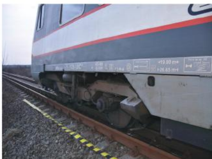
Imaginea nr. 3 – poziția roților deraiate la primul boghiu
