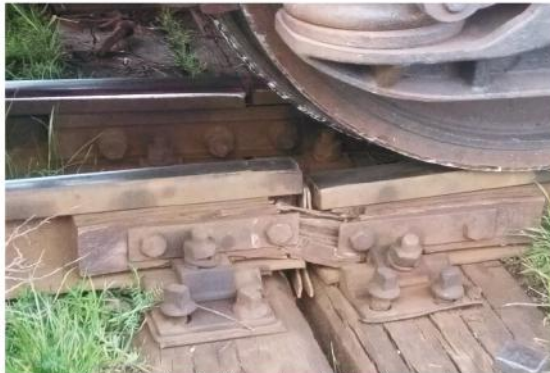
Foto 5: starea joantă premergătoare locului producerii escaladării
