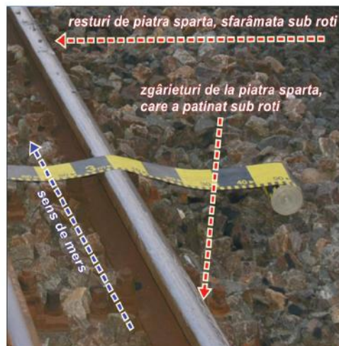
Imaginea nr. 2 – resturi de piatră spartă care a fost sfărâmată de roți zgârieturi făcute de piatră spartă care a patinat sub roți
